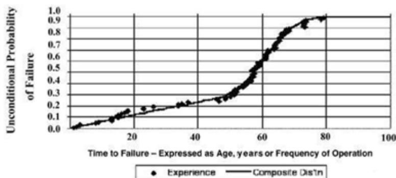
Figura 2: Función de distribución de probabilidad,  $F(t)$ , de fallas catastróficas de las unidades hidrogenadoras de SG.
